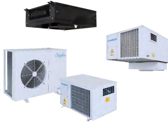
**Descripción** Equipos para acondicionamiento de bodegas, en construcción semicompacta con unidad motocondensadora silenciosa o centrífuga y unidad evaporadora de tipo plafón con doble flujo de aire, dotada de resistencias de calentamiento, sistema de humidificación / deshumidificación, bomba de condensados, y en construcción compacta de techo, con condensación axial o centrífuga.
